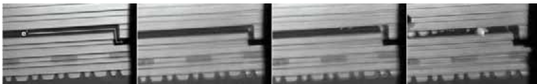
Filmsequenz: Voidbildung in einer Kupferleiterbahn bei Stromdurchfluss.
